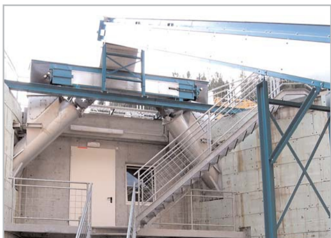
Dopravu neupraveného slamnatého hnoje zajistí robustní dopravníky a speciální vkládací šneky
