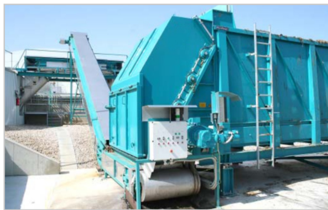
Robustní příjmový dávkovač BTS pro celodenní dávku neupravených vstupních surovin Foto Jiří Trnavský
