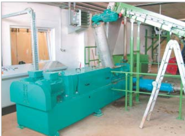
Bioextrudér pro moderní způsob úpravy vstupních surovin Foto archiv firmy
