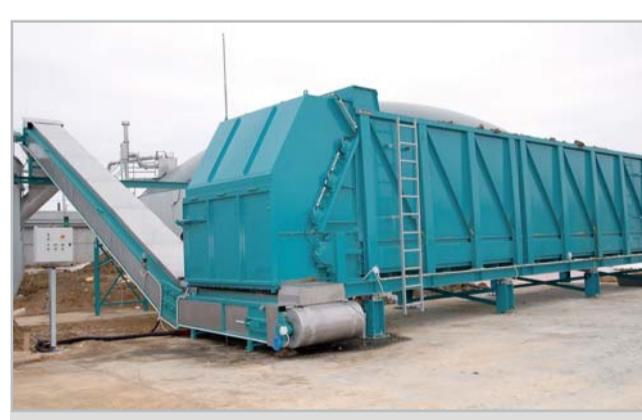
Robustní dávkovač pevných substrátů s dopravníkem umožňující dávkování i složitých surovin
